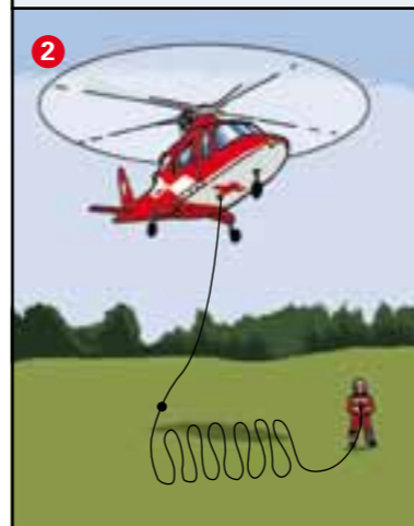
2 Der Helikopter startet und strafft das Seil, bis der Retter am Seilende abhebt.
