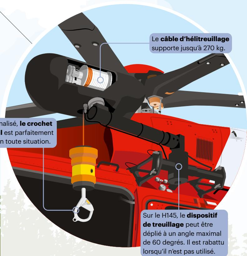
Le **câble d'héltreuilage** supporte jusqu'à 270 kg.
