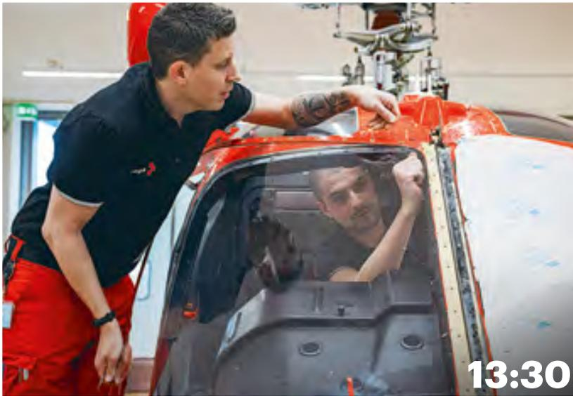
◀ Die Cockpitscheibe muss wegen Haarrissen ausgewechselt werden. Trifft das Sonnenlicht auf diese feinen Risse, verschlechtert dies die Sicht des Piloten.
