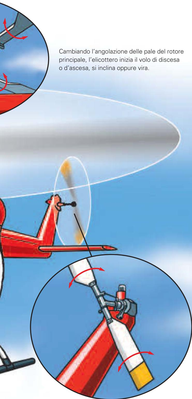
Cambiando l'angolazione delle pale del rotore principale, l'elicottero inizia il volo di discesa o d'ascesa, si inclina oppure vira.
