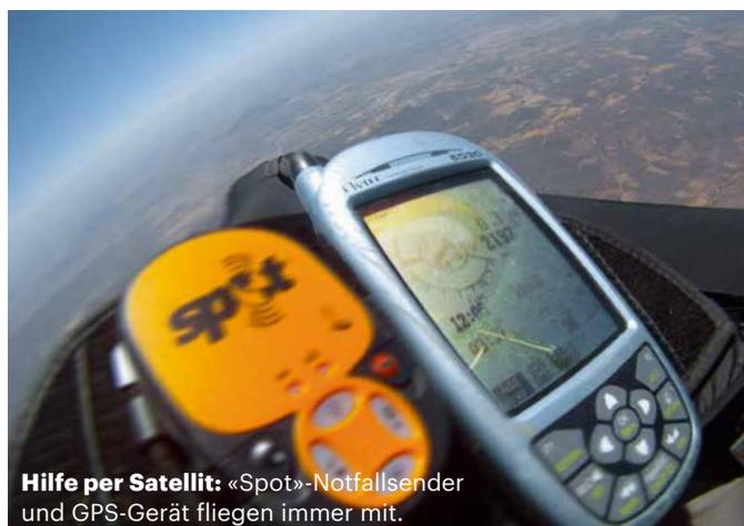
Hilfe per Satellit: «Spot»-Notfallsender und GPS-Gerät fliegen immer mit.
