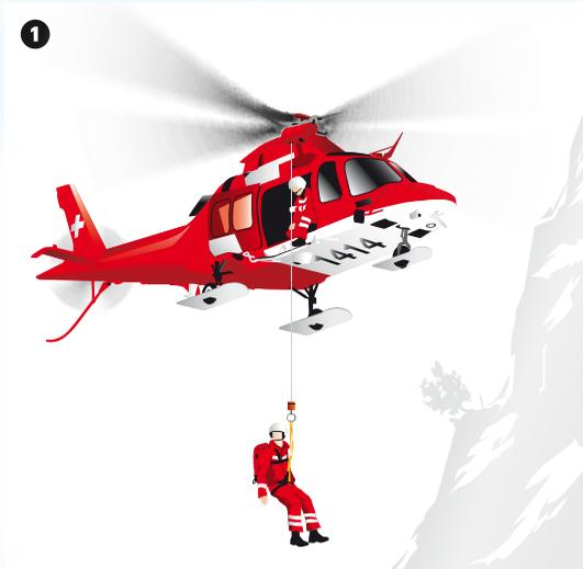
Der Windenoperator sichert den Notarzt und lässt ihn an der Rettungswinde zum Patienten hinunter. Da die Sicht des Piloten nach unten eingeschränkt ist, wird jede einzelne Aktion über die Bordsprechanlage kommuniziert: «Notarzt an der Winde gesichert ... Bereit zum Abwinden ... Arzt ab ... Winde läuft ... 80 Meter ... 60 ... 40 ... noch einen Meter zum Grund.»
