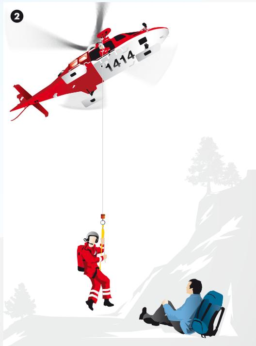
Vier Meter über Boden gibt der Notarzt ein Zeichen, damit der Windenoperator weiss, dass er bald den Boden erreicht. Sanft bremst dieser die Winde ab und setzt den Arzt am Boden ab. Je nach Situation bleibt der Pilot in der Schwebelage über dem Unfallort. Oder er sucht sich einen Platz zum Landen und Warten.
