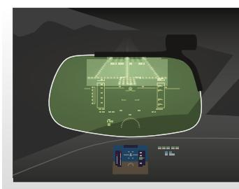
Outre des données de vol spécifiques, une image thermique de l'environnement peut être projetée sur un écran situé directement dans le champ de vision des pilotes grâce à une caméra infrarouge équipant le nez de l'aéronef.
