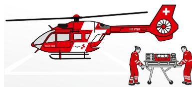
Les exigences imposées à l'intérieur des hélicoptères de la Rega sont extrêmement complexes : il doit être le plus léger possible tout en étant assez robuste pour supporter des forces pouvant atteindre 20 g (force de gravité) dans les cas extrêmes, comme l'imposent les normes de sécurité aérienne AESA. En outre, les équipages doivent pouvoir installer sans outils et en un minimum de temps des appareils spéciaux, par exemple pour le transport de prématurés.
