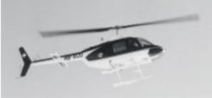
**Le Bell 206A, premier hélicoptère à turbine** Le Jet Ranger HB-XCU ne dispose pas de treuil. Seul un câble fixe permet de mener à bien des sauvetages en montagne quand l'atterrissage est impossible.
