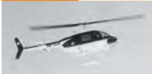
**Bell 206A, il primo elicottero a turbina** Il "Jet-Ranger" HB-XCU dispone di una turbina ma non ha il verricello. I salvataggi alpini senza possibilità d'atterraggio sono possibili solo con il gancio e la fune fissi.
