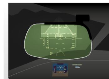
Outre des données de vol spécifiques, une image thermique de l'environnement peut être projetée sur un écran situé directement dans le champ de vision des pilotes grâce à une caméra infrarouge équipant le nez de l'aéronef.
