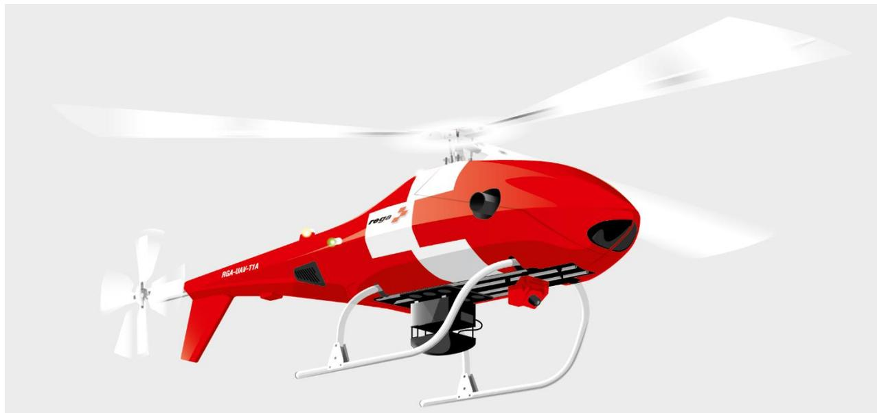
Il drone Rega combina la tecnologia più moderna con l'esperienza pluridecennale della Rega nelle missioni di ricerca di persone scomparse, ferite o malate. Volò autonomamente su grandi aree di ricerca ed è dotato di vari sistemi di ricerca. Viene ad esempio utilizzato quando la scarsa visibilità rende impossibile l'impiego di un elicottero.
